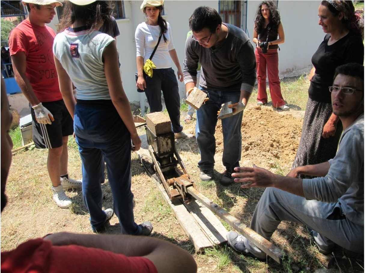
Şekil 16 . Uygulamalı ARCH 325 dersi kapsamında ODTÜ öğrencilerinin geleneksel yöntemler ile kerpiç üretimi
