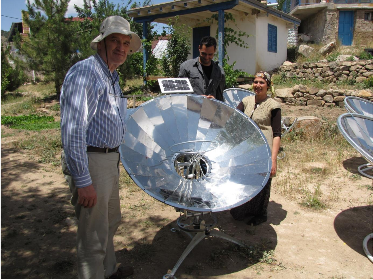
Şekil 14 . Köy kadınlarının isteklerine uygun tasarlanan motorize güneş ocağı
